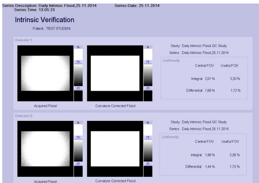
Slika 13. Primjer rezultata za intrinzičnu uniformnost.
