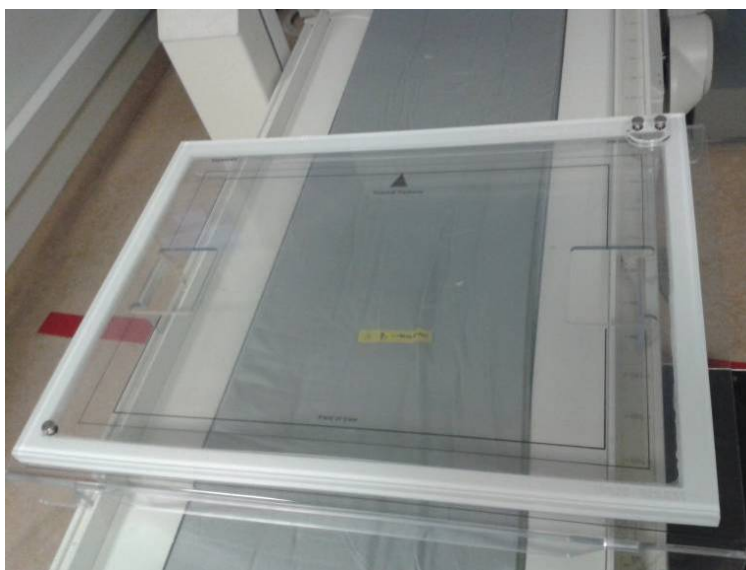
Slika 24. Ravni plastični kvadar napunjen s Tc99m.
