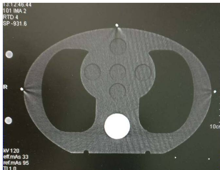
Slika 49. Analiza slike za provjeru točnosti topograma.
