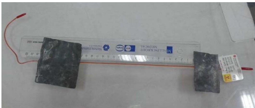
Slika 31. Linijski izvor koji se koristi za provjeru udaljenosti.
