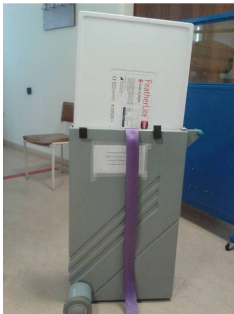
Slika 15. Ravni izvor Co57 za provjeru ekstrinzične uniformnosti.
