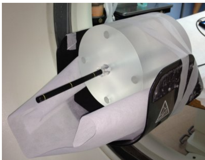
Slika 51. Postavke mjerenja za CTDI u zraku.
