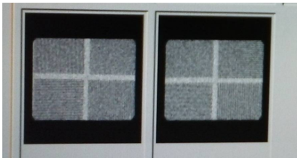
Slika 26. Primjer rezultata za intrinzičnu prostornu rezoluciju.
