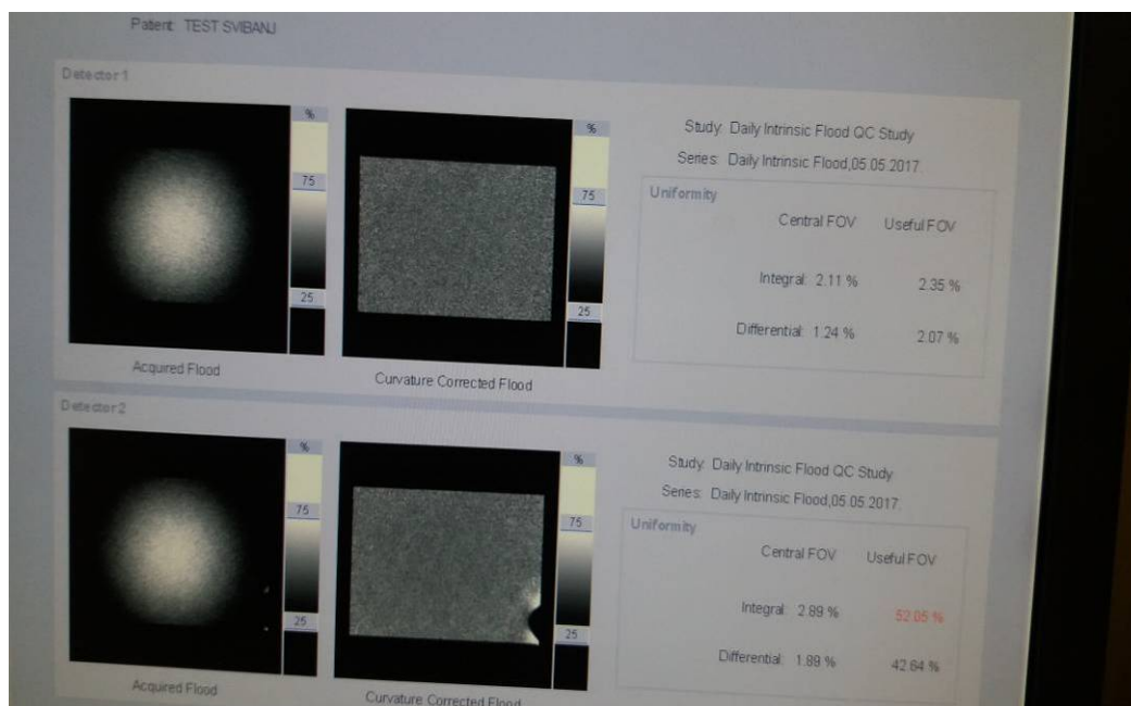
Slika 14. Primjer rezultata izvan tolerancije: uniformnost na drugom detektoru je 52.05% zbog ispada rubnog fotomultiplikatora.
